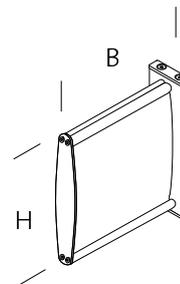
Fahنشilder erhalten Sie in beschriftungs- und montagefertiger Ausführung. Die Fahنشilder sind immer doppelseitig. Die beiden Schildprofile sind mit einer Wandkonsole und einer Profilabdeckung verbunden. Die Wandkonsole verfügt über Schlüsselbohrungen für eine verdeckte Wandmontage.
