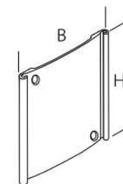
Alle Schilder erhalten Sie in montagefertiger Ausführung. Komplett mit eingesetzten Abschlußnieten aus Edelstahl und Abdeckscheibe in anti-reflex/klar. Die Türschilder sind gebohrt für Wandbefestigung.
