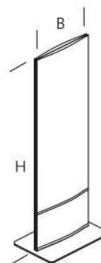
Für den Innenbereich, aufgebaut und geliefert wie die Orientierungstafeln für Wandbefestigung, jedoch doppelseitig und freistehend mit Tellerfuß aus Stahlblech DB 703 (anthrazit metallic).
