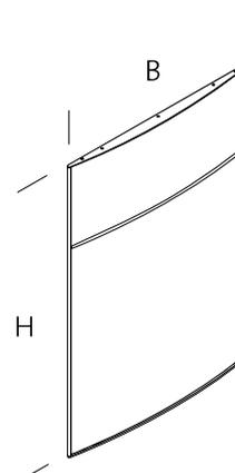
Die Schilder erhalten Sie in beschriftungs- und montagefertiger Ausführung komplett montiert geliefert (inkl. Unterplatte aus Aluminiumblech eloxiert-silber und Abdeckscheibe). Alle Orientierungstafeln können mit Trennstegen unterteilt werden. Geben Sie an, wo ein Trennsteg eingesetzt werden soll, damit wir die Abdeckscheibe auf Maß zuschneiden können.
