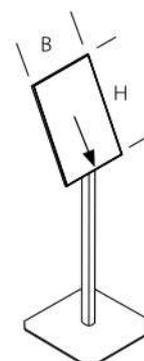
Der doppelseitige, umlaufende Rahmen gibt dem Informationsständer einen eleganten und dezenten Ausdruck. Mit dem mitgelieferten Winkelschraubendreher lässt sich der Informationsständer einseitig **nach unten** öffnen und wieder manipulationssicher verschließen. Diese ausgeklügelte Rahmenbauweise sorgt für einen einfachen Einlegerwechsel. Die mitgelieferte, entspiegelte Abdeckscheibe bietet dem Einleger ausreichend Schutz. Der Informationsständer wird mit Standfuß geliefert.
