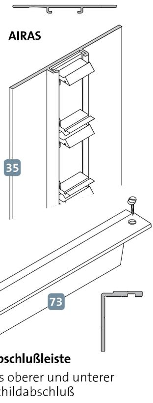
Zusätzlich können Wegweiser, die mit der Randleiste Radius gebaut sind mit einem oberen und unteren Abschluß aus 2 waagerechten Viertelstableisten und 4 Eckteilen versehen werden.
