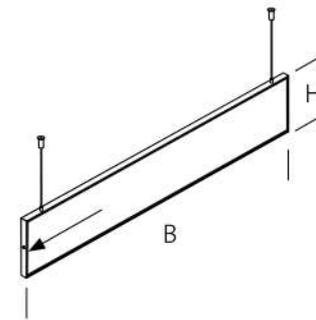
Der doppelseitige, umlaufende Rahmen gibt dem Deckenhänger einen eleganten und dezenten Ausdruck. Mit dem mitgelieferten Winkelschraubendreher lässt sich der Deckenhänger einseitig **zur Seite** öffnen und wieder manipulations-sicher verschließen. Diese ausgeklügelte Rahmenbauweise sorgt für einen einfachen Einlegerwechsel. Die mitgelieferten, entspiegelten Abdeckscheiben bieten dem Einleger ausreichend Schutz. Die Deckenabhangung wird montagefertig mitgeliefert.
