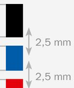
Aufgrund der erforderlichen Abstände zwischen Farbbereichen (2,5 mm) und der Mindestgröße einer Farbfläche (8 x 8 mm) kann sich die Schriftgröße oder die maximale Zeilenanzahl gegenüber herkömmlichen einfarbigen Abdrucken etwas reduzieren.
