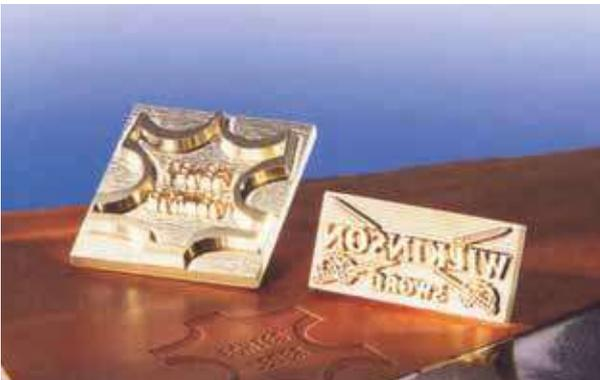
(Messingstempel erhaben graviert) Diese Messingstempel werden in einer Heißprägemaschine zur Kennzeichnung von Leder, Kunststoffen (insbesondere Kunststoffetuis und Verpackungen), Papier etc. eingesetzt. Die Kennzeichnung erfolgt mit oder ohne Farbfolie unter Zufuhr von Wärme. Die Prägung ist dauerhaft und lässt sich nicht wieder entfernen, da der Stempel das Material umformt.
